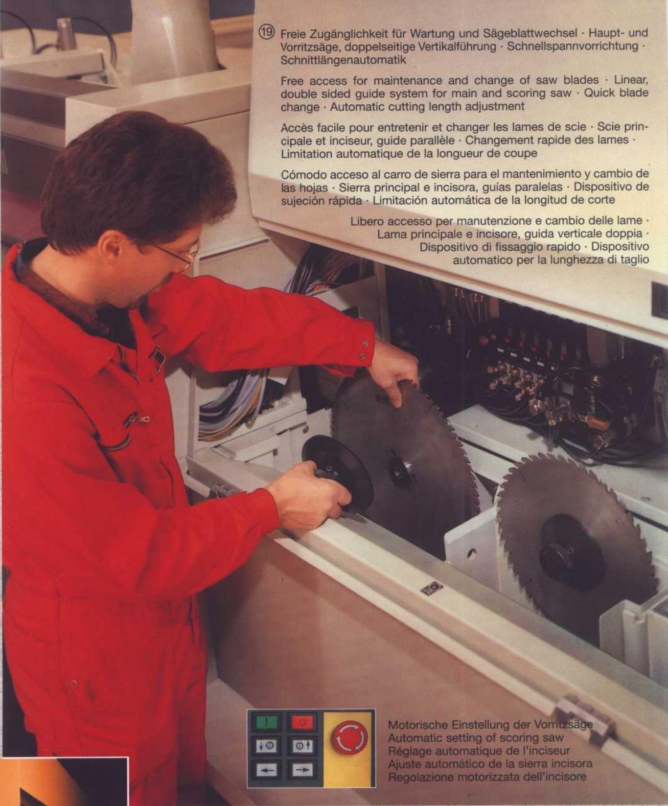
①9 Freie Zugänglichkeit für Wartung und Sägeblattwechsel · Haupt- und Vorritzsäge, doppelseitige Vertikalführung · Schnellspannvorrichtung · Schnittlängenautomatik
